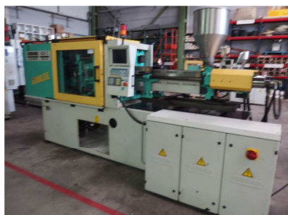
Inyectora termoplastico 100 ton.
